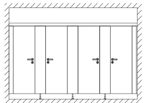
**PRIMO** als standoptimierte Variante mit Füßen in den Zwischenwänden
