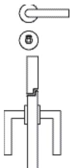
Sicherheitsdrücker in U-Form aus farbigem Nylon, Aluminium oder Edelstahl mit Schauscheibe.
